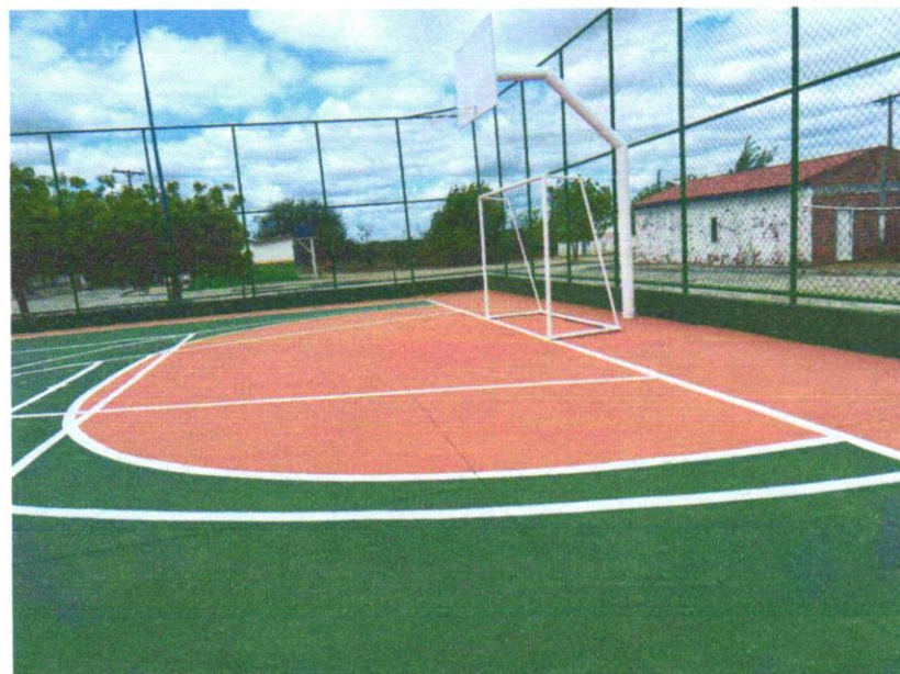
Foto 02 – Traves oficial para futebol de salão 3x2m em aço galv.3", com requadro e redes de polietileno fio 4mm (conjunto p/futsal)
